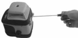
Ajustez la vis de réglage fin
