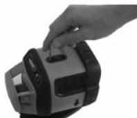
Calibrez la fiole à l'aide d'une clé hexagonale 2,5 mm
